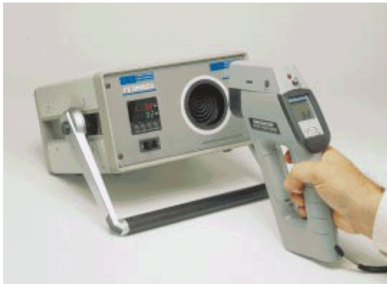
Figura 8.3.6.A. Calibrazione di un pirometro su un corpo nero di riferimento [Omega Transactions].
